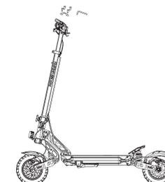
3. Die Schrauben anziehen und den Netzschalter überprüfen.
