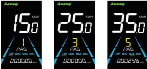
Figure 5-4 PAS level display interface
