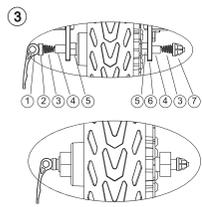
4. Setzen Sie die Schnellspannachsen in der richtigen Reihenfolge ein, fixieren Sie diese und ziehen Sie den Griff zuletzt fest.
