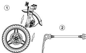
3. Setzen Sie das Vorderrad ein und achten Sie auf die Ausrichtung der Scheibenbremse.
