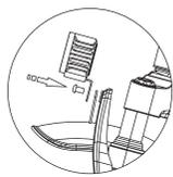
2. Achten Sie auf die Reihenfolge beim Einbau des Kotflügels und des Vorderlichts und ziehen Sie die Schrauben fest.
