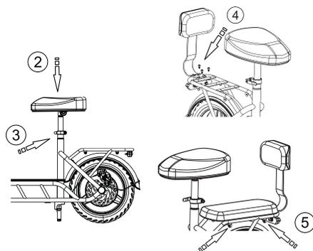
8. ① Bauen Sie den Sitz zusammen, ② setzen Sie den Sitz in die Stütze ein, ③ verriegeln Sie den Verschluss; ④ installieren Sie die Rückenlehne, ⑤ montieren Sie das hintere Sitzkissen.
