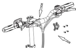
1. Montieren Sie den Lenker und ziehen Sie die Schrauben fest.
