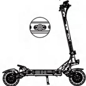
1. Ouvrez le bouchon étanche du port de charge et insérez le connecteur du chargeur dans le trou de charge sur le corps de la trottinette.
