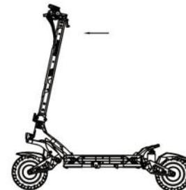
4. Avvitare le viti usando gli attrezzi forniti e verificare se l'interruttore di alimentazione funzioni correttamente dopo l'assemblaggio
