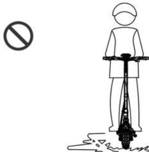
11. Non immergere il prodotto in acqua con una profondità superiore a 1 cm per evitare di danneggiare le parti elettriche del veicolo a causa dell'ingresso di acqua
