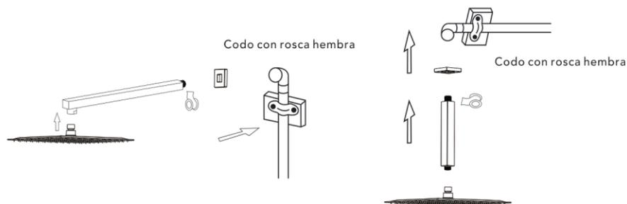
1. Conecte el brazo de la ducha con la cubierta antes de atornillar el brazo en la conexión del elevador para prevenir daños.
